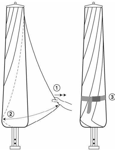
1. Nach dem Schliessen des Schirms alle Stoffbahnen einzeln und vollständig zwischen den Streben hervorziehen.
